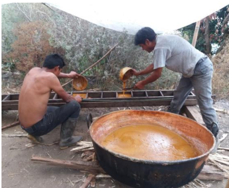
Figura # 26 Foto – Colocación de la panela líquida en los moldes # 1
