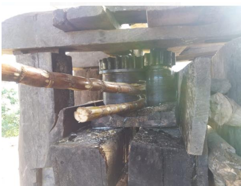
Figura # 14 Foto – Proceso de extracción del jugo de la caña de azúcar # 1 Fuente: Investigación propia Elaborado por: José Elías Arellano Quinatoa
