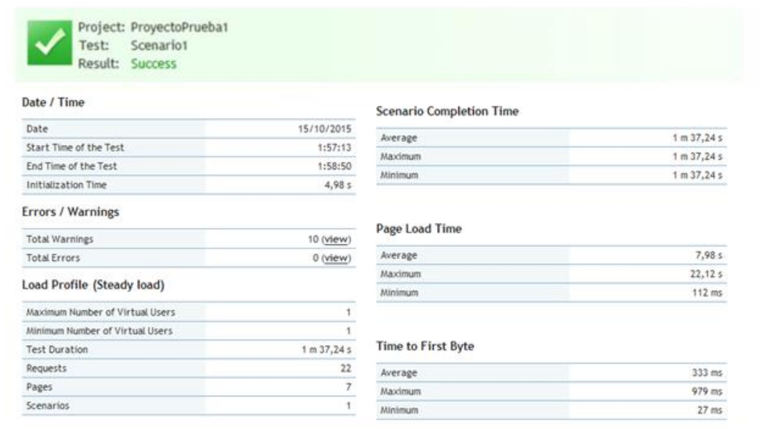
Figura 50. Grafica de muestra el resultado de la prueba que se ha ejecutado sin problemas con un solo usuario.
