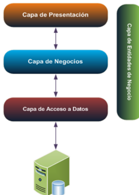
Figura 32. Arquitectura de Software basada en tres capas.
