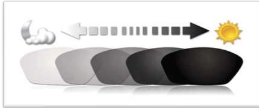
Figura N. 12. Función de lentes fotosensibles
