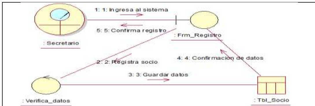
Figura 23: DC002 Registrar Socio para inscribir a un socio debe ingresar al sistema para realizar el registro del usuario en donde se validara los campos requeridos para que su registro sea sin problemas.
